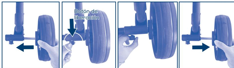
**3.- ENSAMBLE DE LAS RUEDAS TRASERAS:** Inserte el eje de la rueda trasera en el agujero de la terminal plástica del chasis, empuje hacia adentro hasta escuchar un "click" que indicará que ha quedado asegurada. Repita la operación en la otra rueda. Para quitar las ruedas jale el botón de liberación y jale hacia afuera la rueda.
