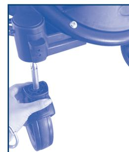
**2.- ENSAMBLE DE LAS RUEDAS DELANTERAS:** Inserte el eje de la rueda delantera en el agujero de la terminal plástica del chasis, empuje hacia arriba hasta escuchar un "click" que indicará que ha quedado asegurada. Repita la operación en la otra rueda. Para quitar las ruedas oprima el botón de liberación y jale hacia abajo la rueda.
