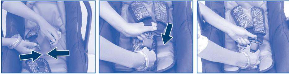
**16.- CINTURÓN DE SEGURIDAD DE LA SILLA:** Alinie las lengüetas de las hebillas de los cinturones de los hombros, enseguida unalas e insertelas dentro de la hebillas central, presionelas hacia adentro hasta escuchar un "click" que indicará que han quedado aseguradas.
