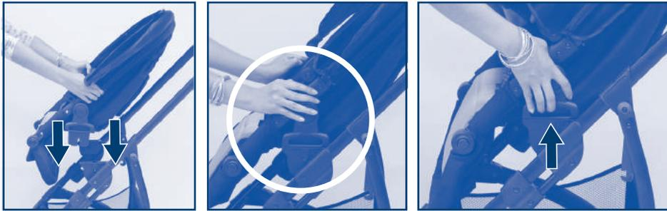
**4.- PARA INSTALAR EL ASIENTO:** Alinee las terminales del nodo central del asiento con las ranuras de la parte central del chasis, introduzca las terminales y empujelas hacia abajo hasta escuchar un "click" que indicará que han quedado aseguradas.
