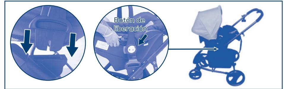
**13.- COLOCACIÓN DE LA SILLA PORTABEBÉ:** Alíne los enganches de la parte inferior de la silla con las ranuras de la parte central del chasis, empuje hacia abajo la silla hasta escuchar un "click" que indicará que han quedado asegurada.
